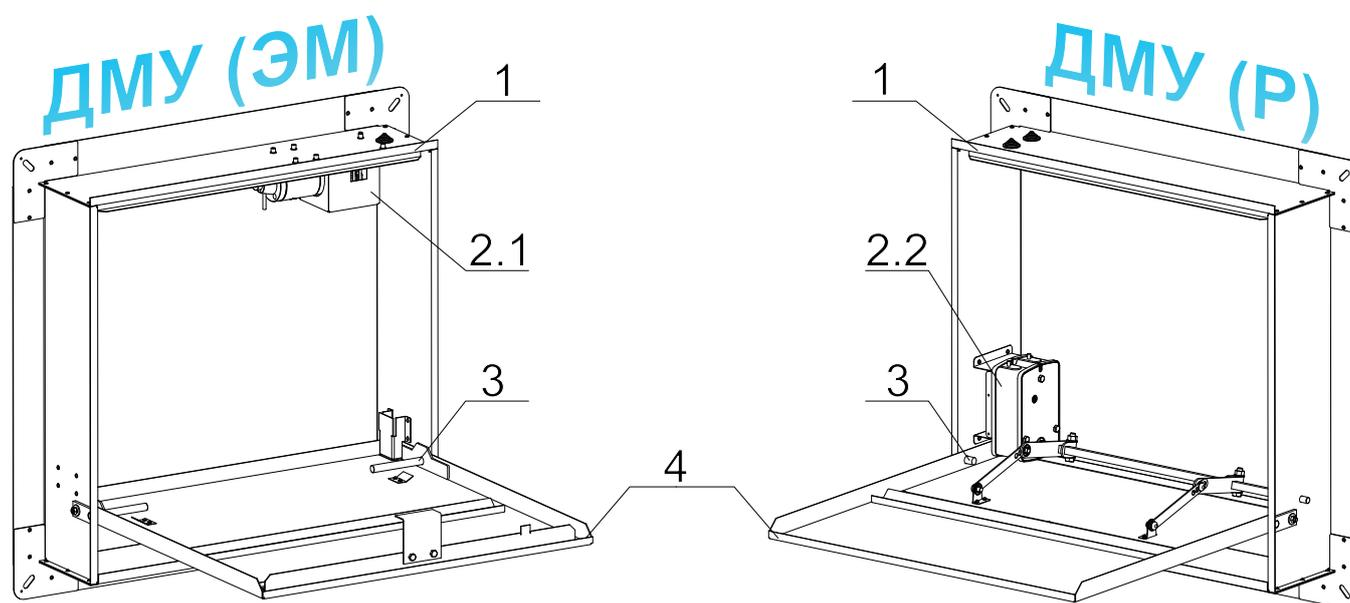
1 – корпус; 2.1 – электромагнитный привод (ЭМ); 2.2 – реверсивный привод (Р);
