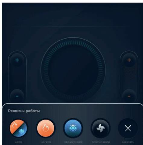
После нажатия на кнопку смены режима работы установки в нижней части экрана отображаются иконки доступных режимов. Для выбора нужного режима необходимо нажать соответствующую иконку. Выход из меню режимов осуществляется однократным нажатием кнопки закрытия.
