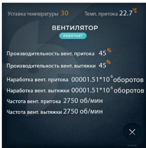
На данном экране можно отслеживать как процент производительности вентиляторов, так и их реальную частоту вращения в об/мин. Кроме того, отображается общая наработка вентиляторов, выраженная в количестве совершённых оборотов (в миллионах).
