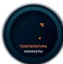
Центральная зона предназначена для отображения текущих параметров микроклимата: температуры приточного воздуха, температуры в помещении, относительной влажности и уровня CO<sub>2</sub>. Переключение между параметрами осуществляется однократным нажатием на центральную область экрана
