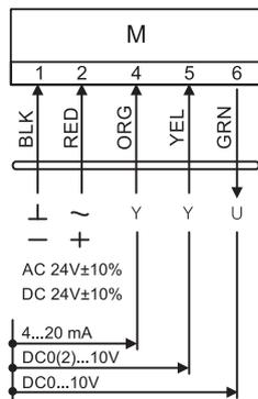
Подключение циркуляционного насоса
