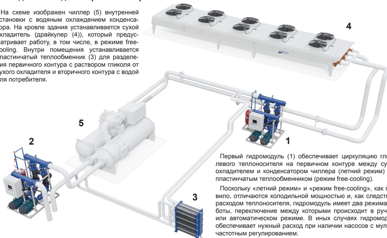
Первый гидромодуль (1) обеспечивает циркуляцию гликолевого теплоносителя на первичном контуре между сухим охладителем и конденсатором чиллера (летний режим) или пластинчатым теплообменником (режим free-cooling).
