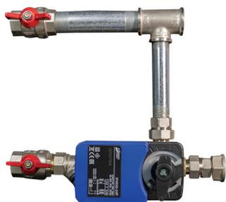
Смесительные узлы СУ-R-4 предназначены для подключения водяных охладителей к магистрали хладоносителя. Позволяют регулировать мощность охлаждения теплообменника, поддерживая заданную температуру воздуха, выходящего из него.
