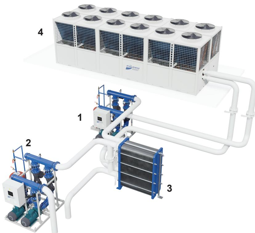
Схема подключения гидромодуля POBEN серии HSR (внутреннего размещения) к чиллеру с воздушным охлаждением конденсатора (моноблок) POBEN серии ARC или аналогичного к приточно-вытяжной установке с водяным теплообменником.
