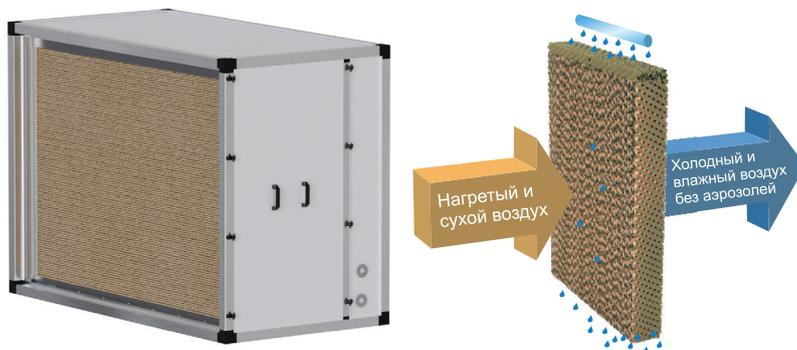
Остаток воды омывает кассету и стекает вниз в поддон. Энергия, необходимая для испарения, берётся из самого воздуха. Поэтому воздух выходящий из увлажнителя, одновременно увлажняется и охлаждается. Пыль, бактерии и микроорганизмы, содержащиеся в поступающем воздухе и минеральные соли, содержащиеся в воде, оседают на поверхности материала кассеты и смываются водой в дренаж. Таким образом весь процесс испарения остаётся чистым. Эффективность увлажнения до 95%.
