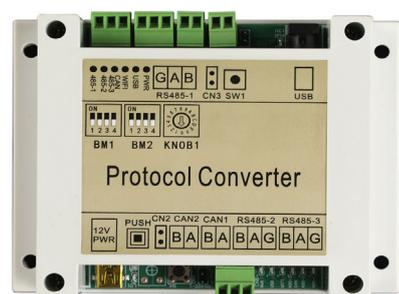
Конвертер сетевой необходим при интеграции системы кондиционирования в централизованную систему управления.
