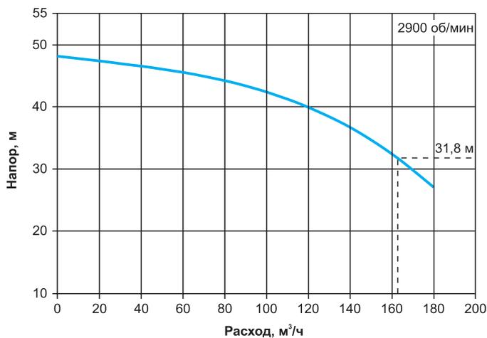
**Расходно-напорные характеристики насосов гидромодулей серии РОВЕН-HSR**
