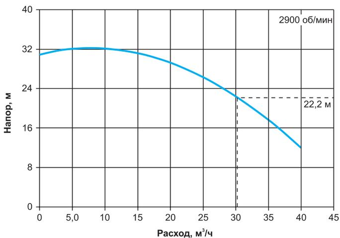
**Расходно-напорные характеристики насосов гидромодулей серии РОВЕН-HSR**
