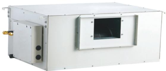
Высоконапорные внутренние блоки RMS-IN...-D1/V2 канального типа предназначены для работы с сетью воздуховодов большой протяженности и способны обеспечить свободное статическое давление до 200 Па (для всех моделей от 6,3 до 14,0 кВт).
