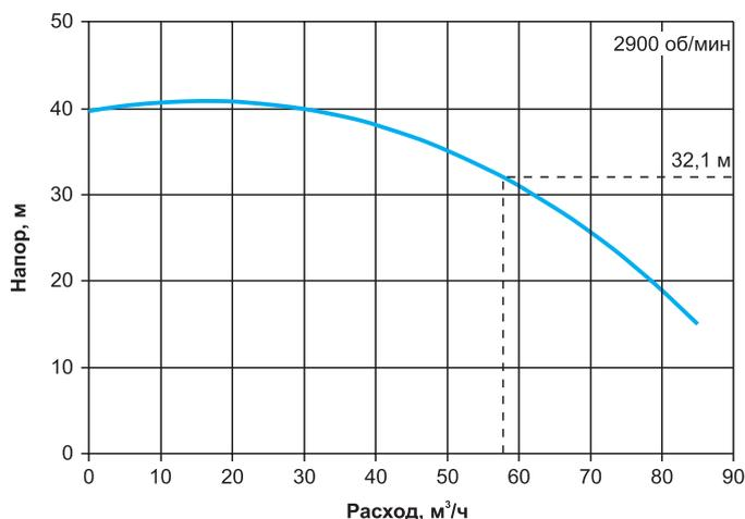
**Расходно-напорные характеристики насосов гидромодулей серии РОВЕН-HSR**
