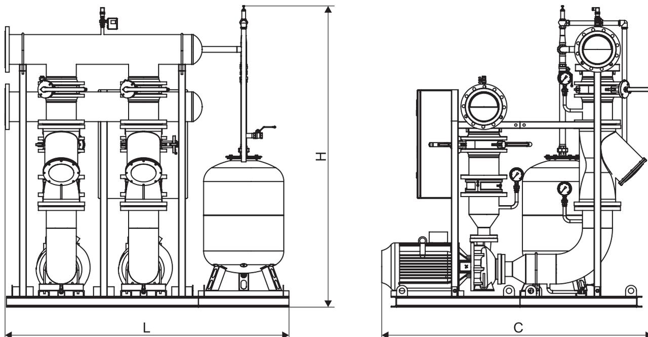
**Габаритные размеры гидромодулей серии POBEN-HSR**
