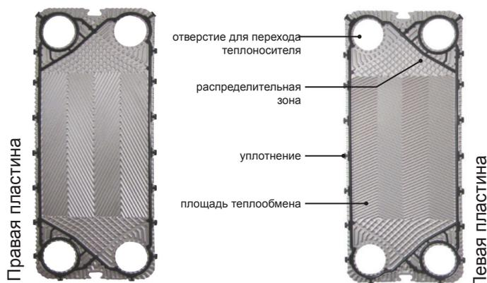
Пластинчатый теплообменный аппарат состоит из пластин одного типа или их комбинации. Количество пластин в теплообменном аппарате и их компоновка, зависит от тепловой мощности, теплофизических свойств сред, а также температурных параметров и допустимой потери давления.
