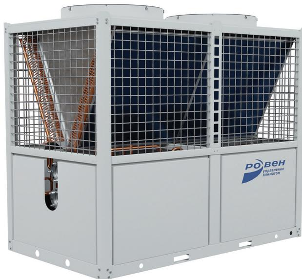
Модульные чиллеры (тепловые насосы) с воздушным охлаждением, оснащенные герметичными спиральными компрессорами, предназначены для охлаждения или нагрева рабочей жидкости. Данные агрегаты - основные источники охлажденной или нагретой жидкости в системе центрального кондиционирования, составными элементами которой являются фанкойлы, радиаторы, приточные установки и другие устройства аналогичного назначения.
