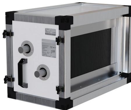
КПД рекуперации доходит до 50%. Проходное сечение теплообменников заполнено алюминиевыми пластинами через которые в шахматном порядке проходят медные трубки. Стальные коллекторы имеют резьбовые соединения для надёжного и герметичного соединения с контуром и выведены за боковую панель со стороны обслуживания. Вытяжная часть рекуператора оснащена поддоном и каплеуловителем для сбора и удаления конденсата.
