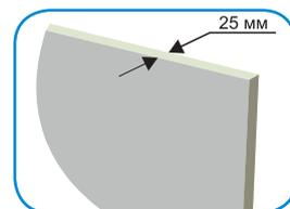
Применение сэндвич-панелей толщиной 25 мм снижает тепловые потери и шум, а также придает дополнительную жесткость конструкции
