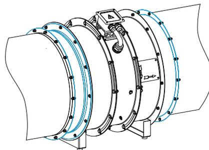
3.4 Решетка БАСКЕТ-РОСА предназначена для защиты осевого вентилятора и системы вентиляции от попадания в них посторонних предметов.
