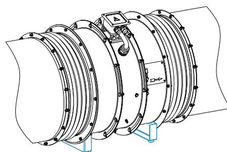
3.2 Вставки гибкие круглые ВГК-РОСА предназначены для предотвращения передачи вибрации от вентилятора к воздуховоду.
