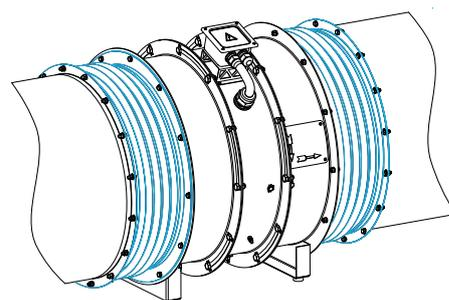
3.3 Переходник РОСА предназначен для жесткого соединения осевого вентилятора РОСА с системой воздуховодов.
