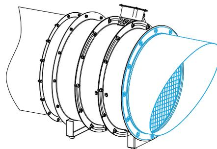
3.6 Типоразмер комплектующих для вентиляторов РОСА подбирается по внутреннему диаметру присоединительного фланца вентилятора.
