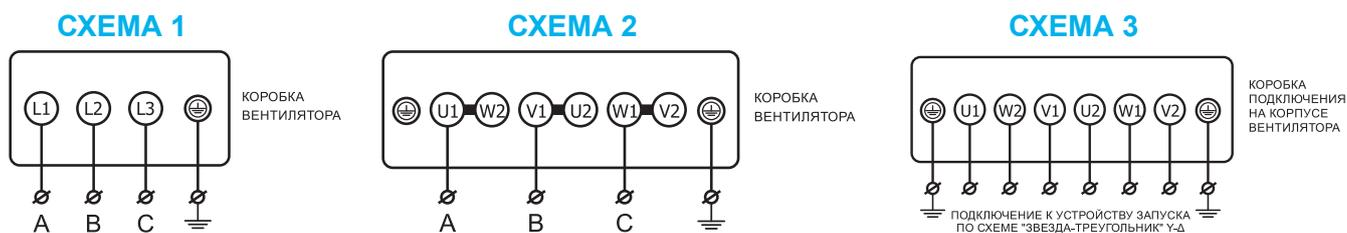
**СХЕМА 1:** для двигателей  $\Delta/Y$  220/380В стандартное подключение Y (звезда);
