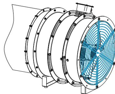
3.5 Козырек РОСА предназначен для защиты осевых вентиляторов РОСА от атмосферных осадков.
