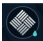
Отображение рекуператора на мнемосхеме позволяет контролировать его текущее состояние. Появление значка в виде капли в правом нижнем углу указывает на **обмерзание рекуператора**. Обмерзание отслеживается автоматически с помощью **датчика перепада давления** или **датчика температуры** в зависимости от конфигурации системы.
