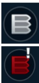
Отображение фильтрующей секции на мнемосхеме позволяет визуально контролировать состояние фильтра. Элемент является кликабельным — при нажатии открывается экран «ФИЛЬТР», на котором отображаются текущий статус фильтра и аварийное сообщение в случае его загрязнения. Если функция «Наработка вентилятора» отключена, параметры наработки до индикации засорения и соответствующая уставка отображаться не будут.
